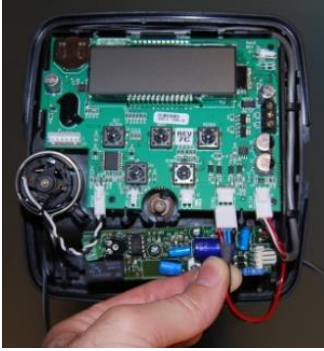
CONECTAR EL CABLE DEL GENERADOR DE CLORO COMO ILUSTRA LA FIGURA
