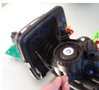
DESMONTAR EL CIRCUITO IMPRESO
