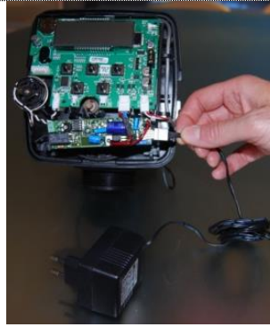
CONECTAR EL CABLE DE ALIMENTACIÓN COMO ILUSTRA LA FIGURA
